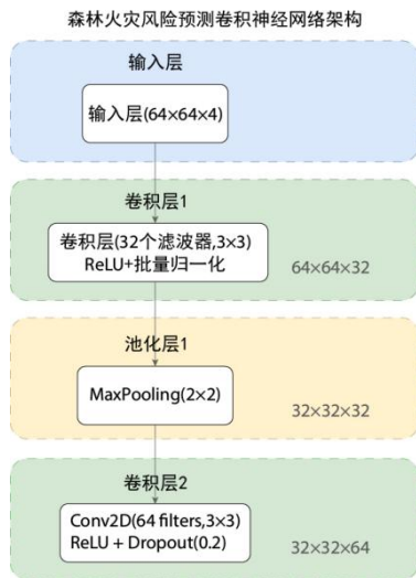
图2 山火风险预测的CNN模型结构
